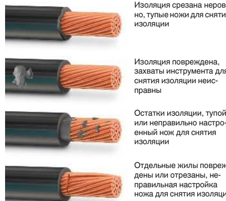
Ошибки снятия изоляции согласно DIN МЭК 60352-2
